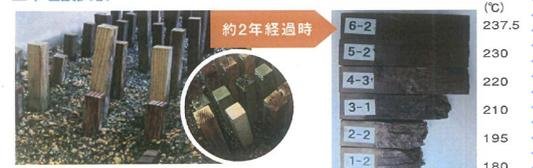
腐朽が起こりやすい高温多湿の室内で土中に処理材を埋めます。野外の土中に埋めた場合と比べてみると、処理温度によって高い耐朽性が証明されています。2~4倍の速さで腐朽が進むと言われています。
