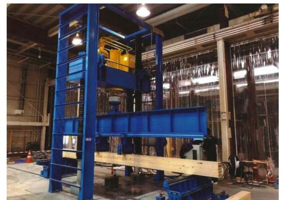
万能実大試験機での曲げ試験
